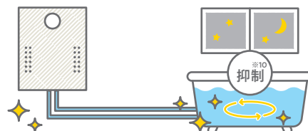
浴槽の循環アダプターから残り湯を吸い込み、給湯器内のLED-UV除菌ユニットでUV照射。
